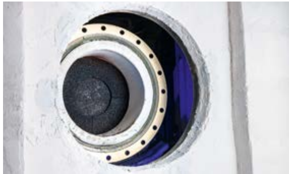
Testreaktor im Solarturm Jülich zur solarthermischen Spaltung von Schwefelsäure.
