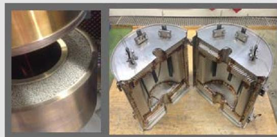
Scherzelle: Probenraum mit Partikeln gefüllt (links), Beheizungseinrichtung mit Isolierung (rechts).
