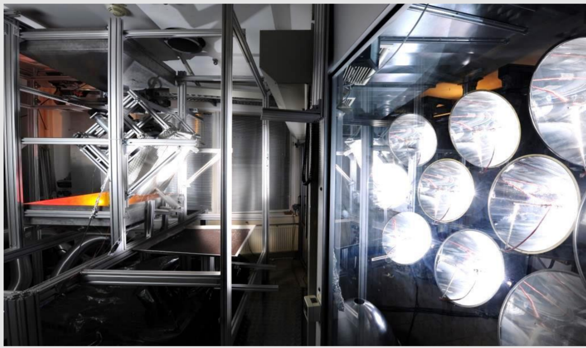
Hochflussdichte-Sonnenofen (SOF) und Xenon-Hochleistungsstrahler (HLS) des DLR-Instituts für Solarforschung am Standort Köln.
