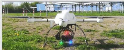
Abb. 4: Messsystem Prototyp für Deflektometriemessung (hier in Jülich). Rote/grüne/blau LED Targets montiert an der Kamera.
