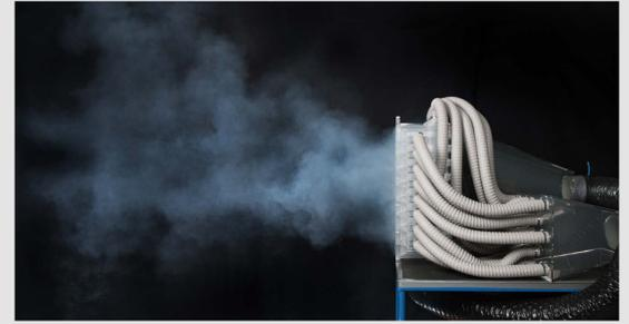
Bild 4: Strömungsvisualisierung mit Nebel
