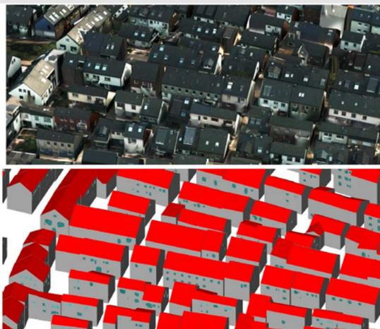
Oben: RGB-texturierte Gebäudemodelle; unten: automatisch erkannte Dach- und Fensterflächen. Bild entnommen aus [1]
