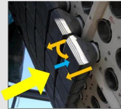
Bild 1: Keramische Absorber in der HiTRec-Receiverstruktur.
