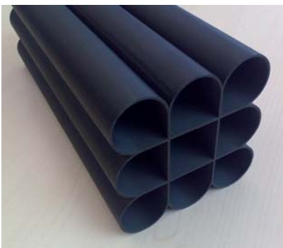
Bild: DLR-Gastank in Waben-Struktur
