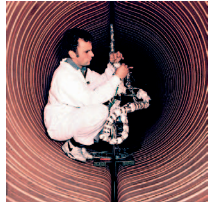
Vakuumkanter der STG. Versuchsraum mit zylindrischer Kryopumpe aus Kupfer.
