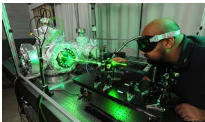
Vakuumanlage zur Untersuchung der Konversionseffizienz nichtlinearer Kristalle Vacuum chamber for investigation of conversion efficiency of nonlinear crystals
