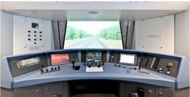
Arbeitsplatz für Triebfahrzeugführer mit originalem Steuerungspult im RailSET®
