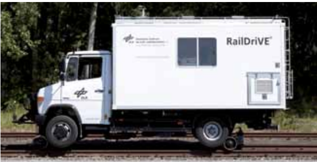
Das RailDrivE®: Versuchs- und Messfahrzeug für Straße und Schiene
