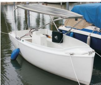
Kopf Solarschiff mit DMFC Range Extender
