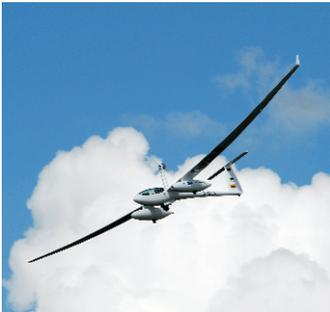
Antares DLR-H2: Flugzeug mit Brennstoffzellen Antrieb
