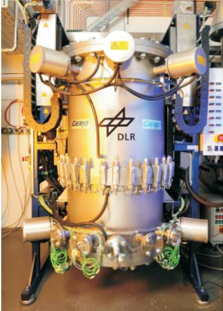
Druckaufgeladener SOFC Teststand bis 8 bar und 1000°C
