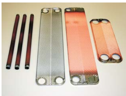
Neu entwickelte Wärmeübertrager-Oberflächen basierend auf poröser Plasma-Beschichtung für Sieden von Kältemittel
