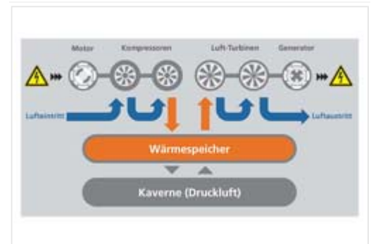
Funktionsschema eines adiabaten Druckluftspeicherkraftwerks
