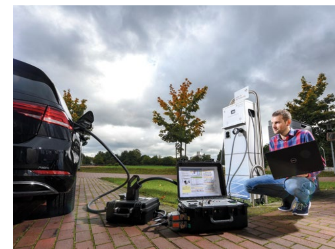
Eine der Ladesäulen des DLR-Standorts Oldenburg ist in einen Versuch eingebunden. Jan Petznik überwacht die wichtigsten Daten des Ladevorgangs.
