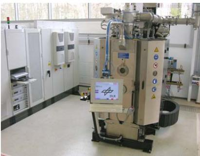
Neben modernsten Vor- und Nachbehandlungsprozessen und Prozessanalytik werden vor allem die neuen Verfahrenstechnologien Gasfluss-Sputtern und Multiquellen-Sputtern eingeführt. Sie eröffnen dem Institut die Möglichkeit, über die aktuellen klassischen Anwendungsfelder Wärmedämmschichten und Oxidationsschutzschichten für Komponenten der fliegenden und stationären Gasturbine hinaus neue Beschichtungssysteme und Anwendungsfelder anzugehen.
