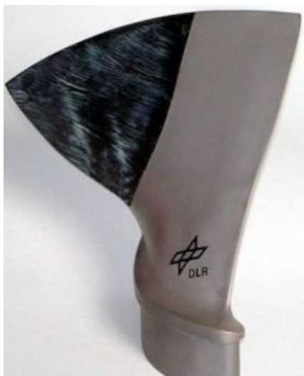
Demonstrator einer Fanschaukel aus CFK, welches adhäsiv an Ti-6Al-4V gefügt wurde
