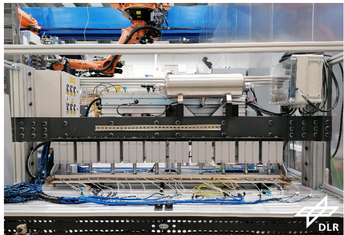
Abbildung 3: Versuchstand für Schweißungen bis 1500mm
