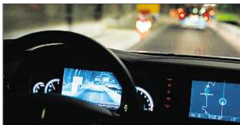
Auch Nachtsicht-Assistenten im Auto funktionieren durch Infrarot. (Foto: dpa)
