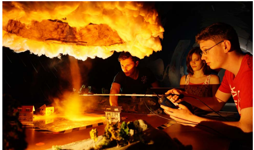
Schülerinnen und Schüler messen den Druckabfall und die Geschwindigkeit im Tornadoschlauch
