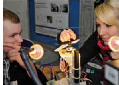
Waage mit Rotor zur Bestimmung des Auftriebs bei unterschiedlichen Anstellwinkeln.
