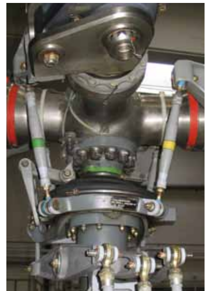
Taumelscheibe eines Hubschraubers zur Steuerung der Anstellwinkel.
