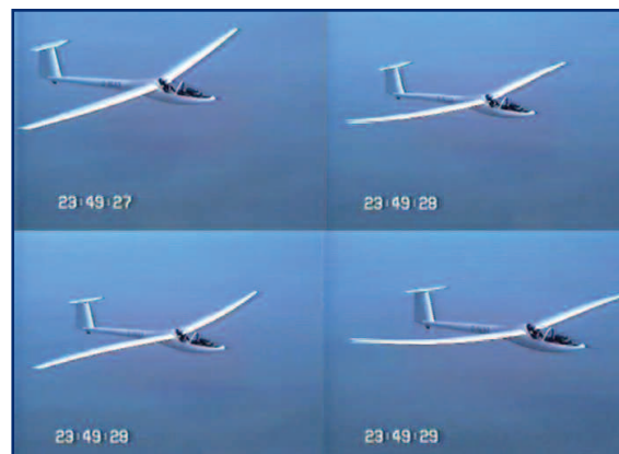
Flattern bei einem Segelflugzeug
