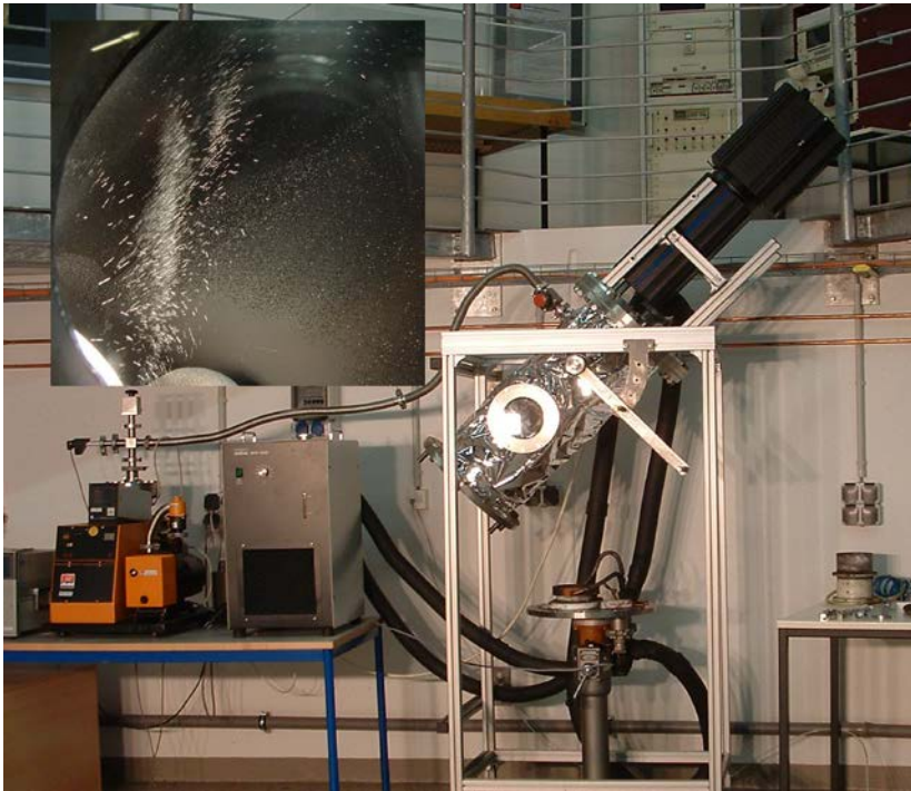
Versuchskammer zur Kometensimulation im DLR_School_Lab Köln
