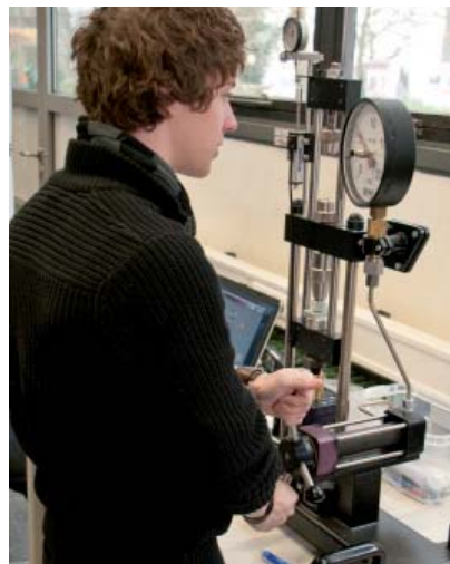
Ein Schüler kontrolliert den aufgebrauchten Druck während der Härteprüfung.
