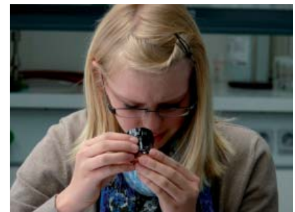
Eine Schülerin misst den Durchmesser des Kugelabdrucks in einem Kupferstück.
