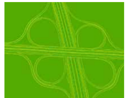
„DriveLines®“ vom AK München-Ost, extrahiert aus unserem Ortho-Bild Mosaik. Die Extraktion erfolgte zunächst in einem manuellen Prozess, um Referenzdaten zum Test des automatisierten Verfahrens zu gewinnen.
